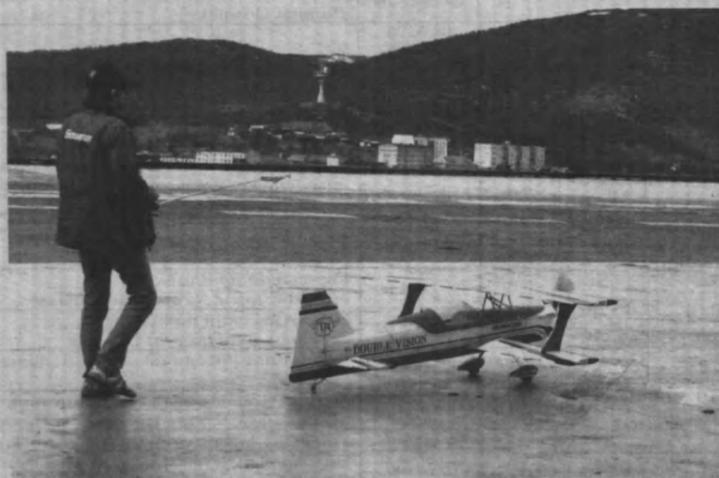
Размах крыльев такого самолета достигает 2,5 метра, вес 13 кг, двигатель бензиновый 50 см<sup>3</sup>, как у мопеда.
